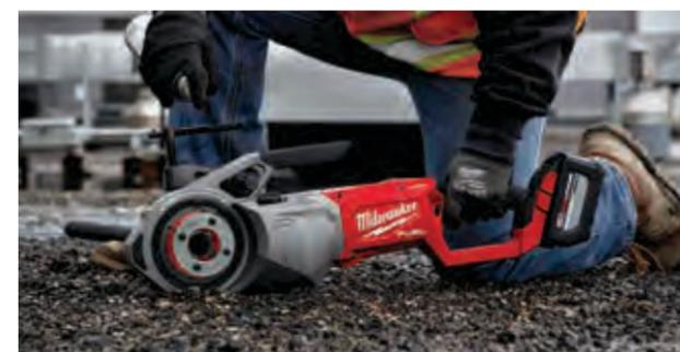
**Herramienta de prensado M18™ FORCE LOGIC™ con ONE-KEY™ con mordazas CTS de 13 mm a 50.80 mm (1/2" a 2")**
