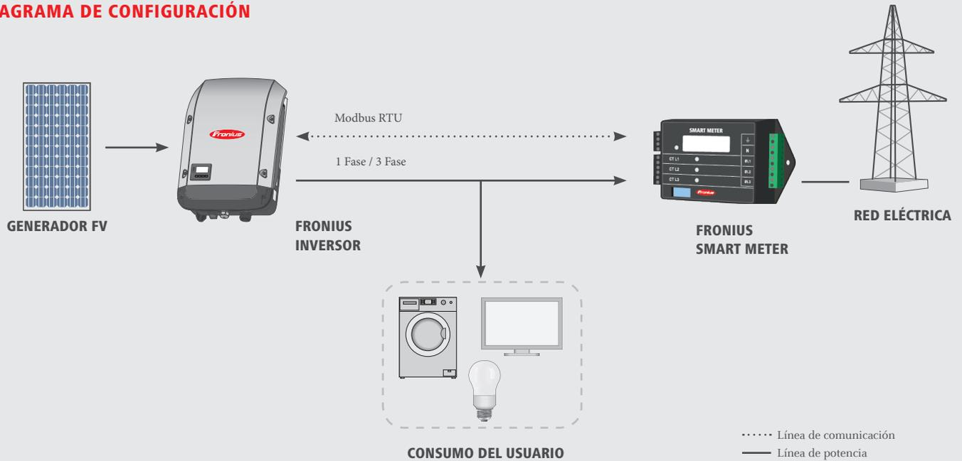
/ El Fronius Smart Meter es compatible con todos los inversores Fronius con un Fronius Datamanager 2.0 integrado (interfaz RS485 para Modbus RTU), que está incluido en los Inversores Fronius Galvo, Fronius Primo, Fronius Symo y puede instalarse en cualquier inversor, Fronius IG, IG Plus e IG Plus A.
